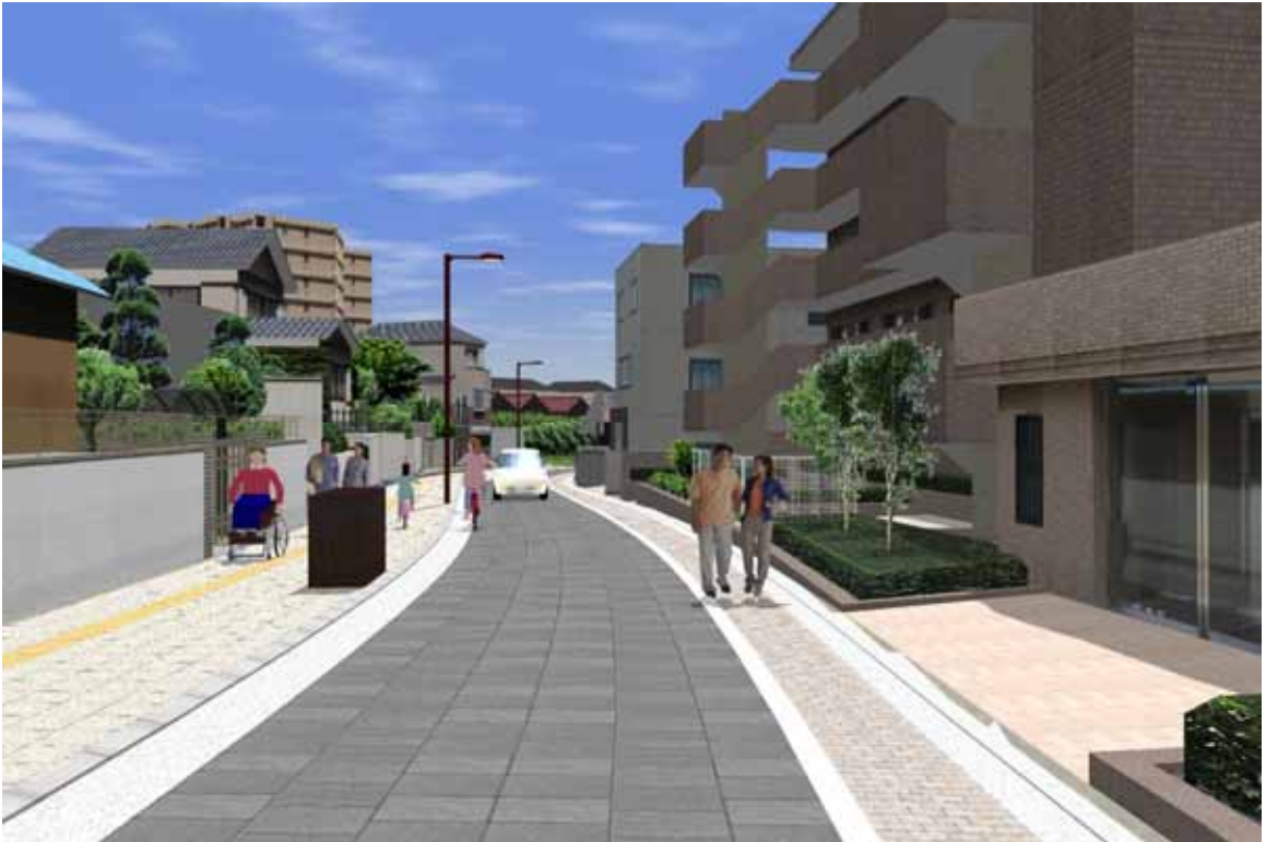
北区間 車道：半たわみ化粧仕上げ舗装、歩道：インターロッキングブロック舗装、 電線類地中化のためのボックス型機器、独立した街灯
