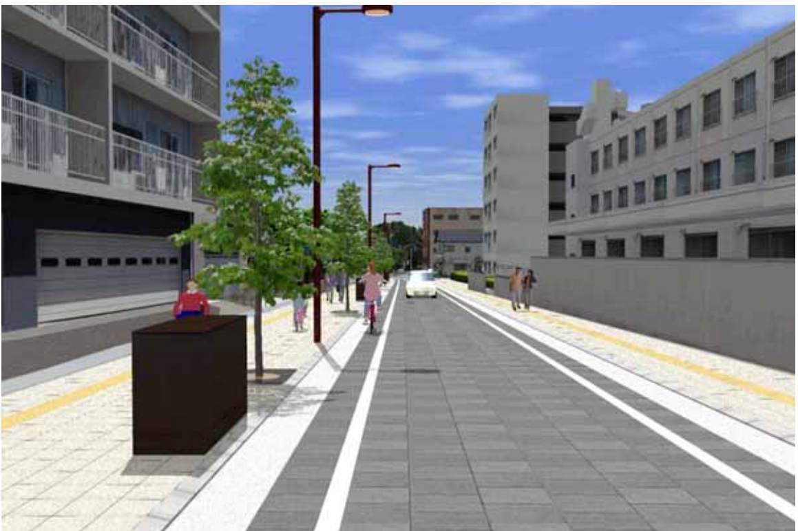
南区間 車道：半たわみ化粧仕上げ舗装、歩道：インターロッキングブロック舗装、 電線類地中化のためのボックス型機器、中木の植栽、独立した街灯
