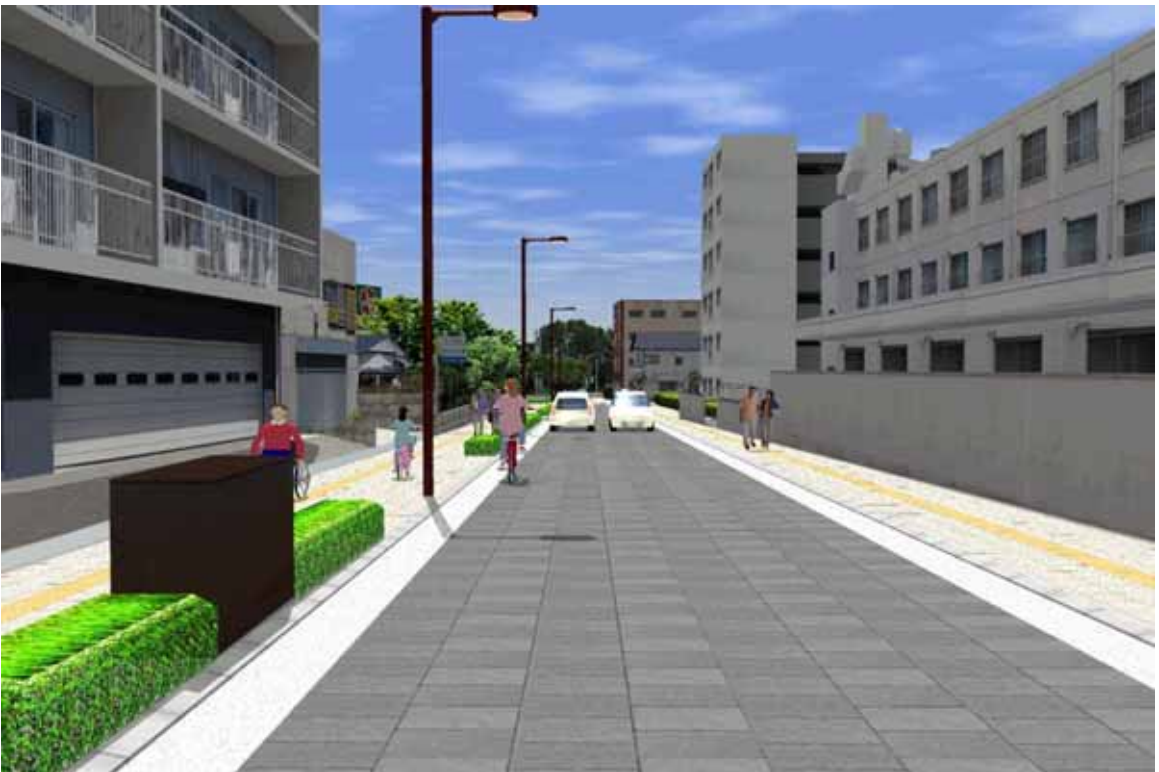
南区間 車道：半たわみ化粧仕上げ舗装、歩道：インターロッキングブロック舗装、 電線類地中化のためのボックス型機器、低木の植栽、独立した街灯
