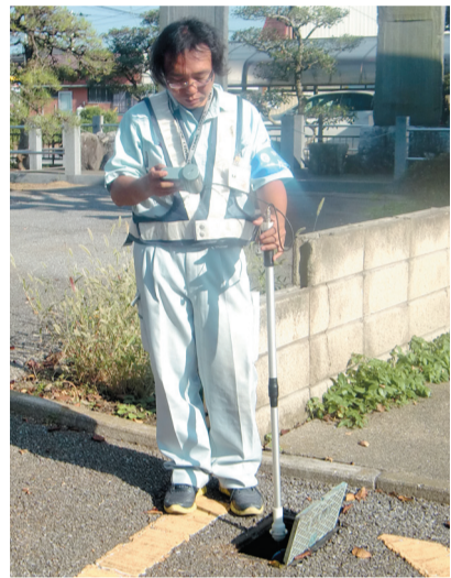
▲漏水調査をしている様子
